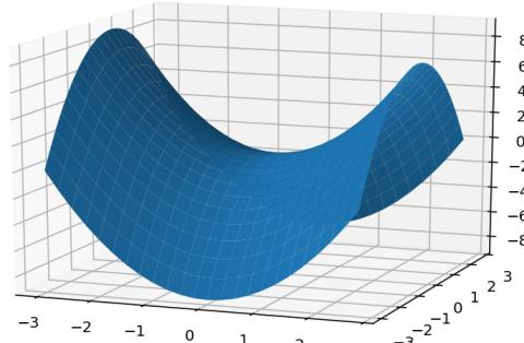
Dが正であることが確認できる。plot3dによって3次元表示すると、鞍のような表面となり、極値でないことが確認できる。すなわち、 $f_{xx}$ の曲率が正、 $f_{yy}$ の曲率は負であり、2方向によって曲率が違った鞍点(saddle point)となる。
