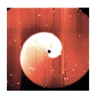
図 3.16: マイクロパイプ欠陥 [5].
